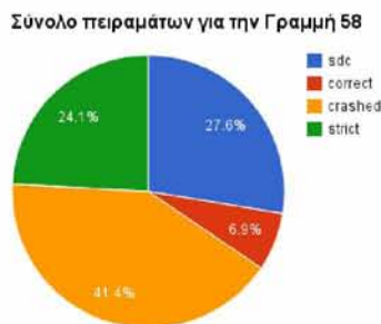
Σχήμα 4.7: Επίδραση κάθε οφάλματος στη γραμμή 56 του αρχικού κώδικα της εφαρμογής MonteCarlo PI
