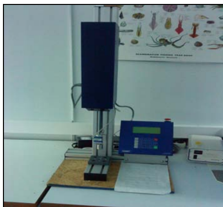
Εικόνα 9: Το ειδικό δυναμόμετρο (Admet Interface SM-250) που χρησιμοποιήθηκε για τις μετρήσεις της σκληρότητας των ξηρών και φρέσκων φύλλων οξιάς.
