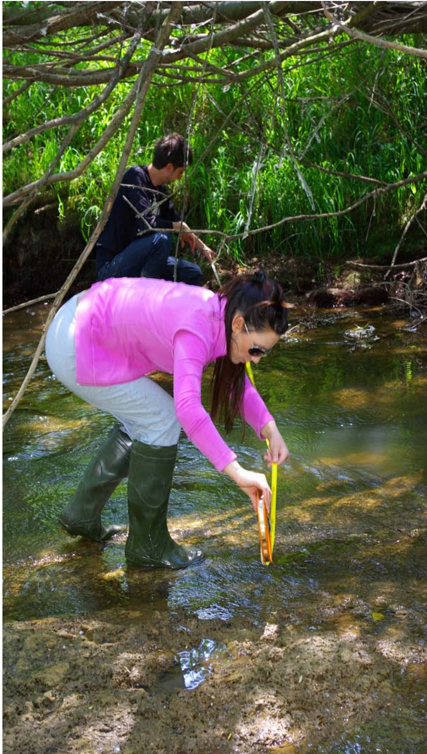
Εικόνα 3.5: Μέτρηση πλάτους με μετροταινία
