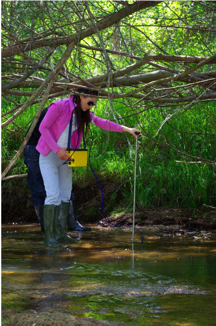
Εικόνα 3.3: Μέτρηση ροής με ροόμετρο
