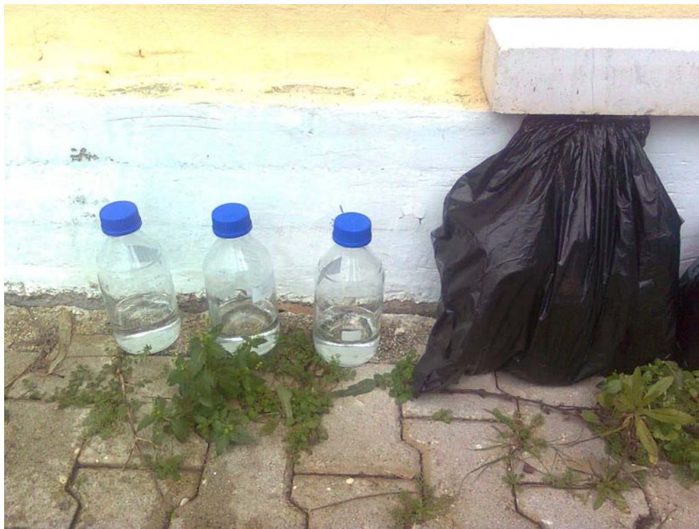
(Εικόνα 5 Φωτογραφία από φιάλες με διαφορ. συγκεντρώσεις τετρακυκλίνης σε φώς και σε σκοτάδι)
