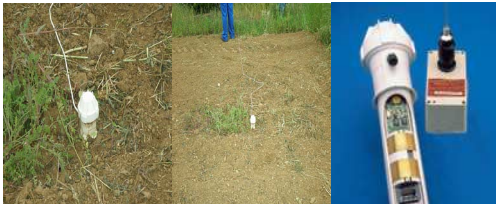
Εικόνα 5.16 Αισθητήρας Μέτρησης της Εδαφικής Υγρασίας Sentek EnviroSMART
