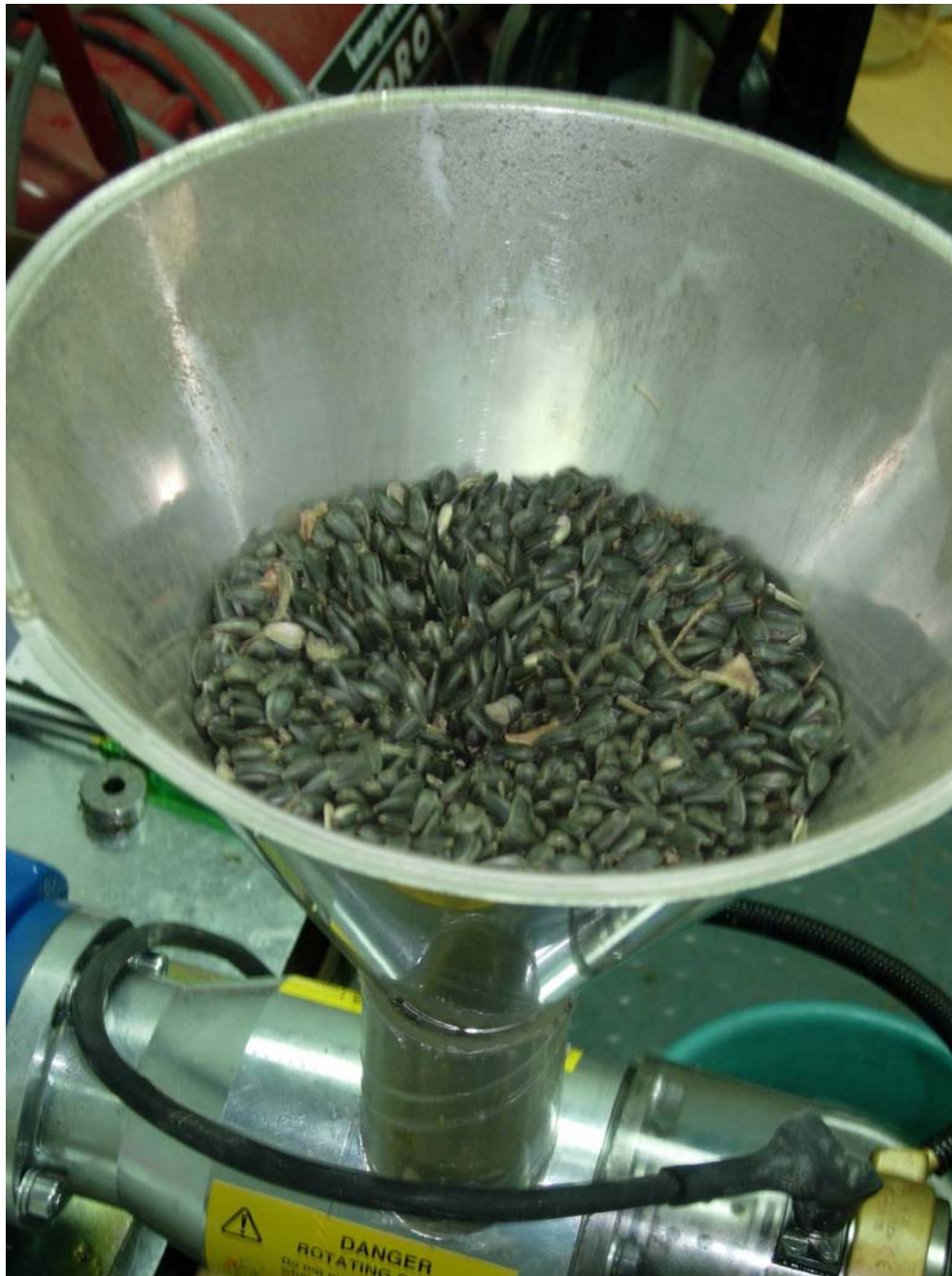
Εικόνα 8. Μηχανή ψυχρής συμπίεσης του σπόρου με κοχλία, εισαγωγή του σπόρου.
