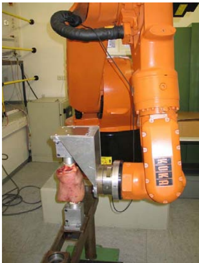
Εικόνα 16. Test set up using a robotic/UFS testing system.
