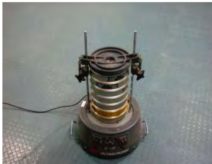
Εικόνα 3.4 Συσκευή κοσκίνισματος με έξι κόσκινα διαφορετικών οπών
