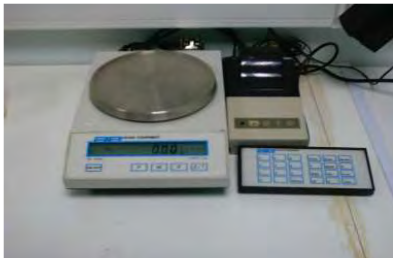
Εικόνα 3.2 Ψηφιακός ζυγός Adam Equipment, ακρίβειας 2 δεκαδικών ψηφίων
