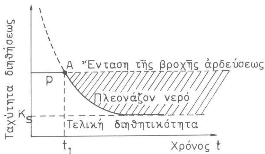
Σχήμα 2.1 Ταχύτητα διήθησης σαν συνάρτηση του χρόνου κατά τη διάρκεια άρδευσης με ένταση σταθερή, μικρότερη από την αρχική τιμή της διηθητικότητας του εδάφους, αλλά μεγαλύτερη από την τελική τιμή αυτής.
