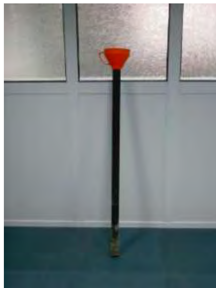
Σχήμα 4.3 Πλαστική σωλήνα για την πλήρωση της στήλης
