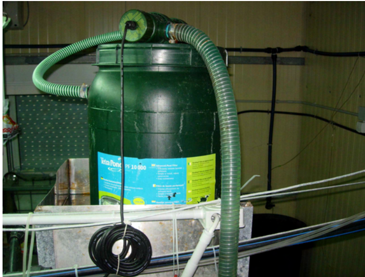
Εικόνα 2.2: Το μηχανικό, χημικό και βιολογικό φίλτρο (φωτογραφία συγγραφέα).
