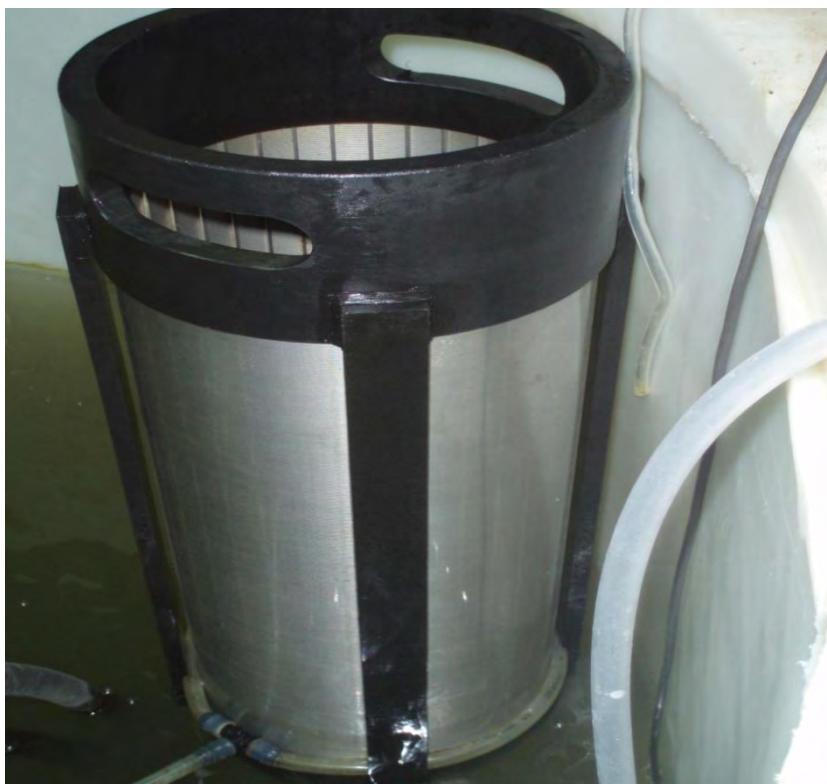
Εικόνα 4: Ανοξείδωτο φίλτρο (rotifilter) για το συνεχές σύστημα καλλιέργειας τροχόζωων (Πηγή: προσωπικό αρχείο συγγραφέα).
