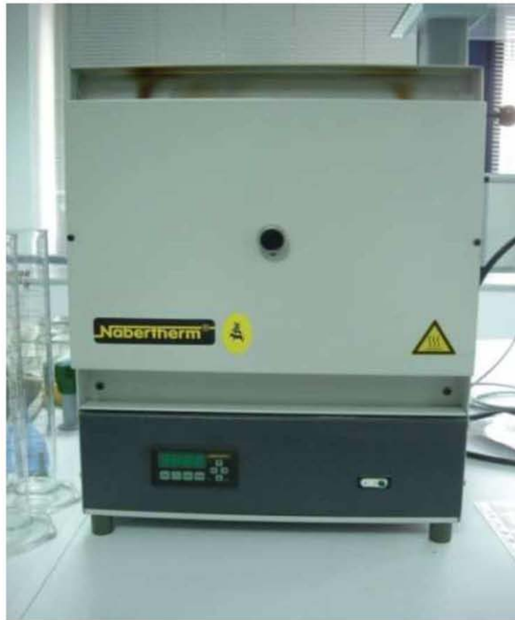
Εικόνα 28. Αποτεφρωτήρας για τον προσδιορισμό της τέφρας στα σιτηρέσια (Πηγή: Προσωπικό αρχείο)
