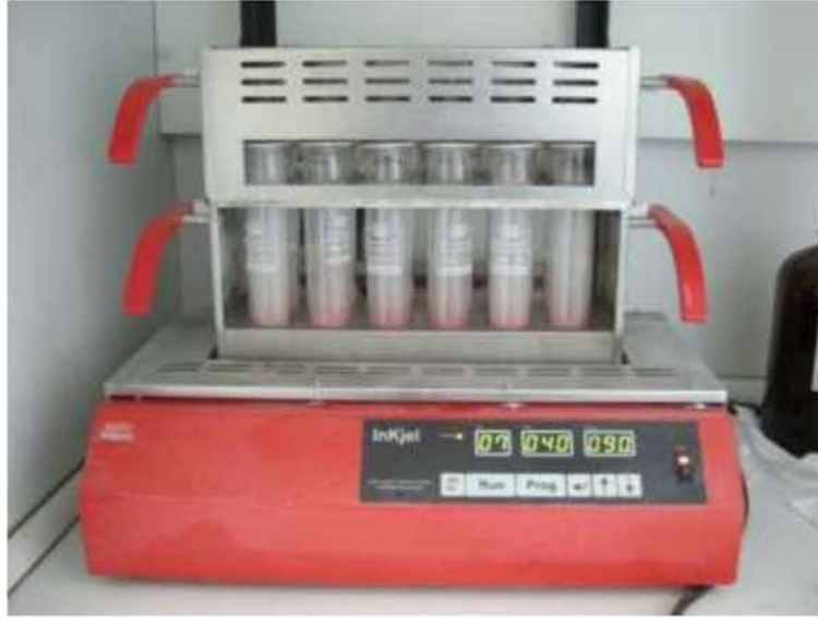
Εικόνα 24. Συσκευή πέψης για μετατροπή του αζώτου σε αμμωνιακά άλατα (Πηγή: Προσωπικό αρχείο)
