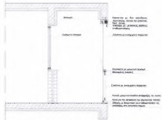
Εικ.5: Πρόταση: Τομή ημιυπεθρίου - ηλιακού χώρου
