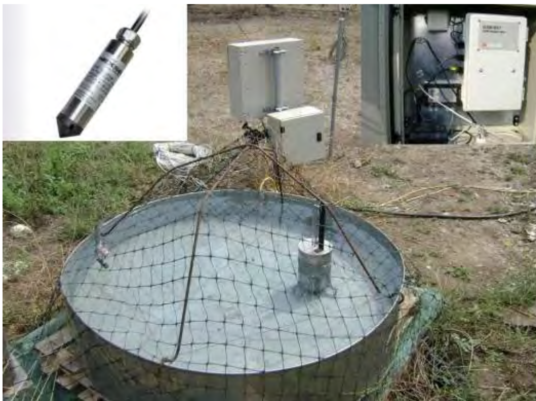
Εικόνα 6.3: Ο αισθητήρας μέτρησης στάθμης νερού εξατμισήμετρου WL1, το εξατμισίμετρο τύπου A και ο data logger.
