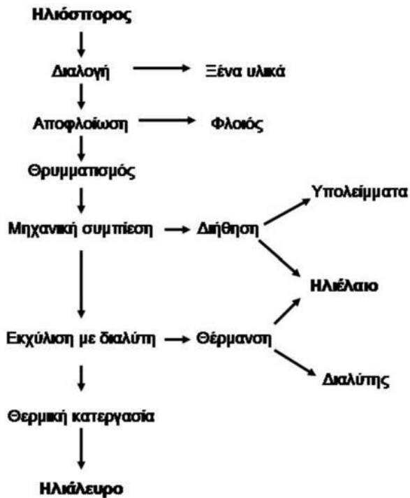
Διάγραμμα 1.3.2. Διάγραμμα ροής των σταδίων κατεργασίας του ηλιόσπορου για την παραλαβή του ηλιελαίου και του ηλιαλεύρου με τη μέθοδο εκχύλισης μετά από συμπίεση
