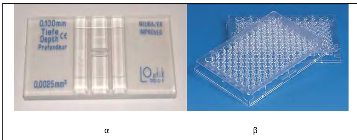
Εικόνα 6: α) αντικειμενοφόρος πλάκα Neubauer, β) 96-well plate.
