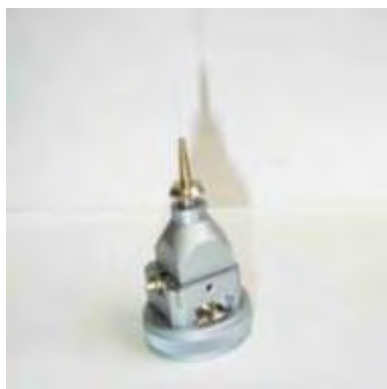
Εικόνα 32. Τριχοειδής σωλήνας τοποθετημένος στο γωνιόμετρο.
