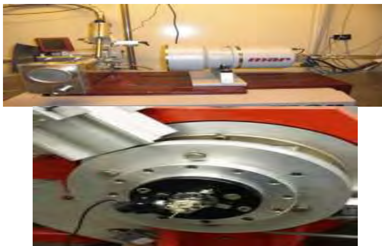
Εικόνα 21: Συσκευή κρυσταλλογραφίας ακτίνων X του εργαστηρίου MAX-lab του Lund University. Κάτω: γωνιόμετρο τοποθετημένο στη ειδική θέση.
