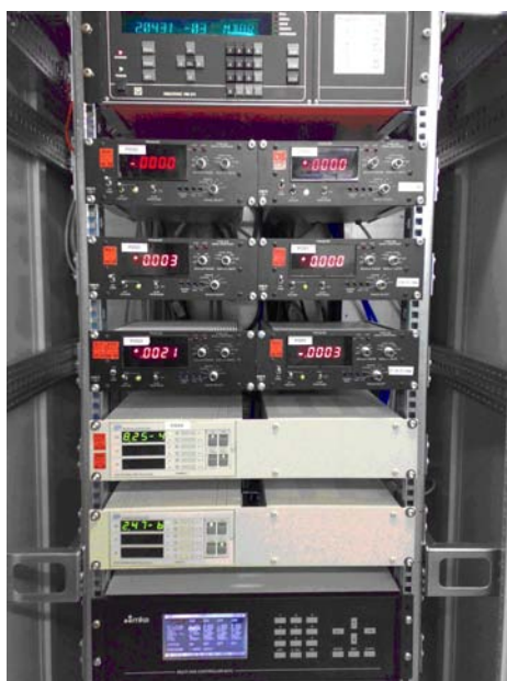
Σχήμα A-2: Ψηφιακές ενδείξεις πίεσης και παροχής.
