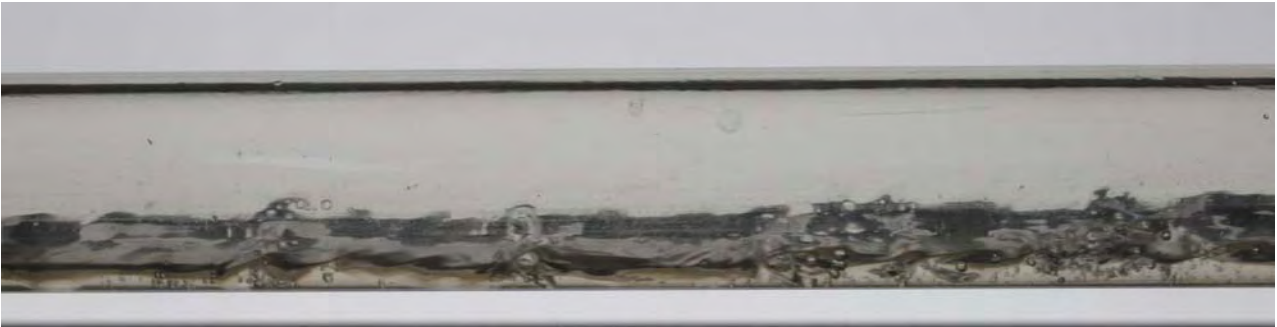
Σχήμα 6.12 K-H κύματα για σύστημα νερού-αέρα για u_{GS}=12.4 m/s και u_{LS}=0.022 m/s
