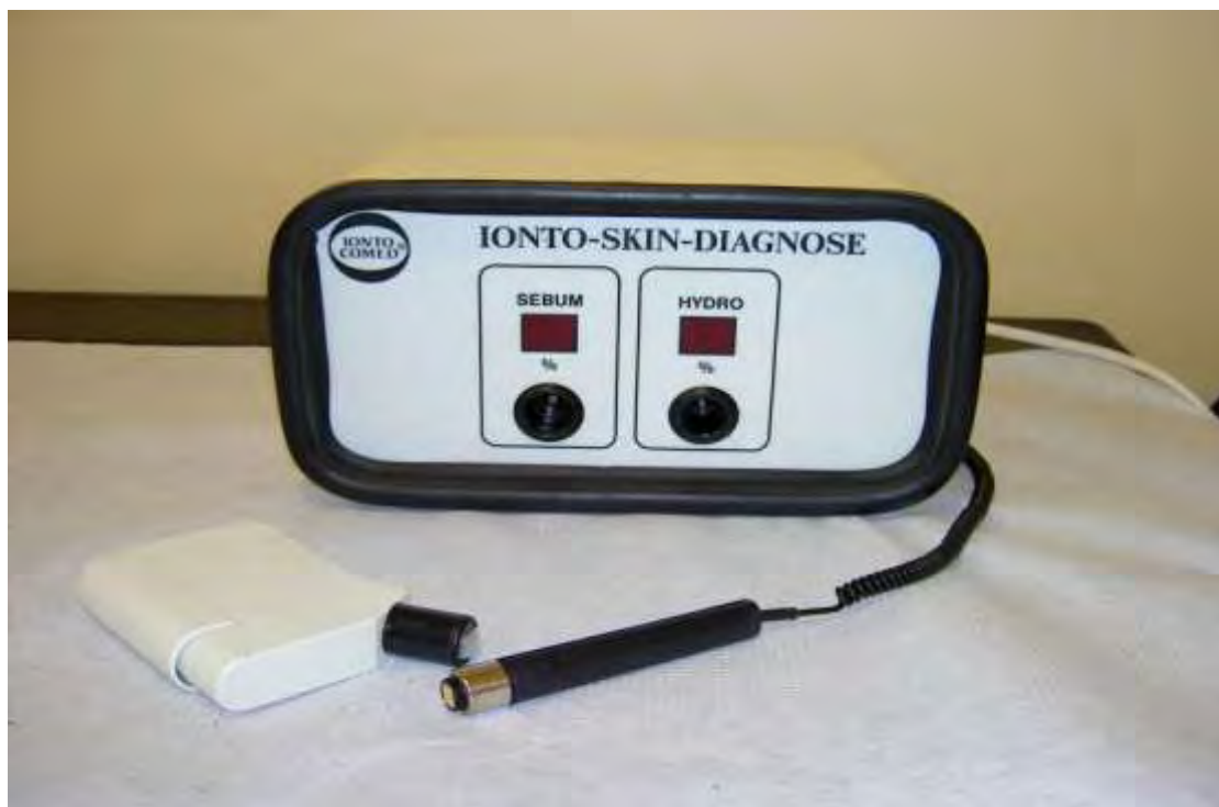
Φωτογραφία 2: Μηχάνημα Ionto-Skin-Diagnose της εταιρίας Ionto Comed που χρησιμοποιήθηκε για την μέτρηση της υγρασίας και της λιπαρότητας του δέρματος.
