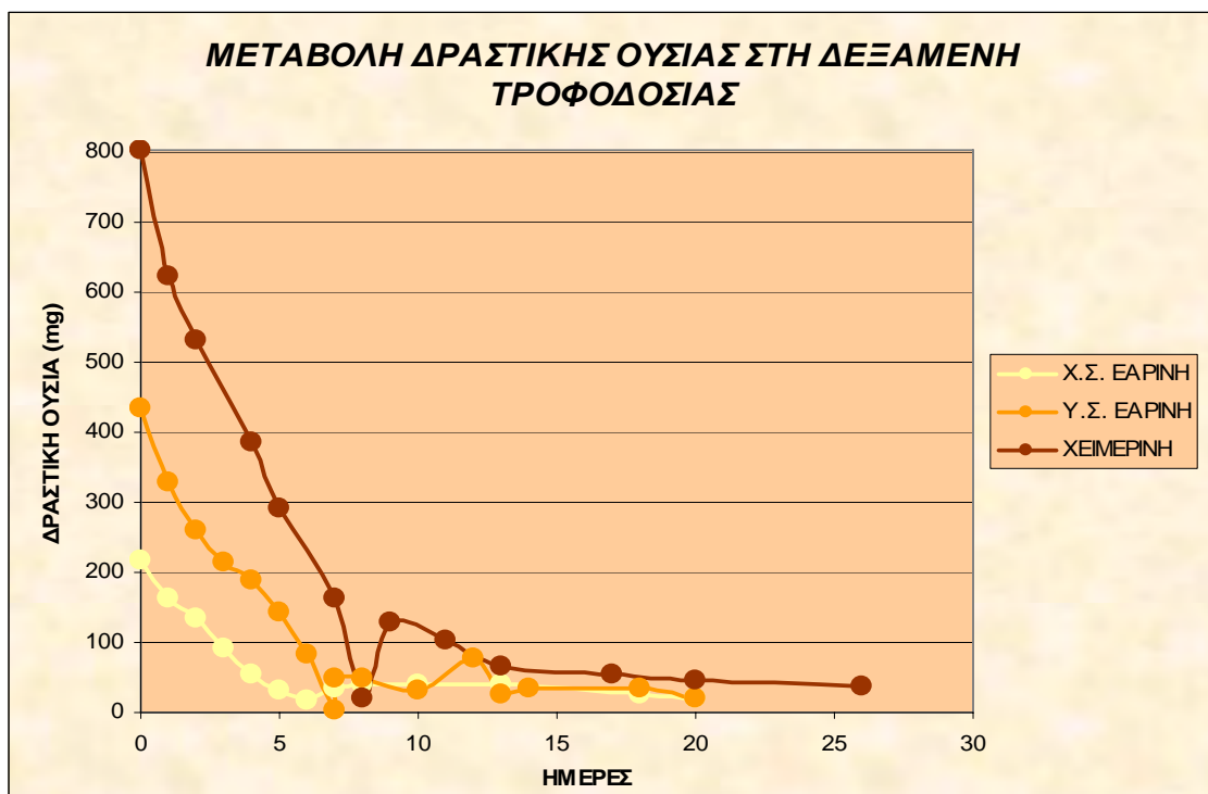
Διάγραμμα 8. Μεταβολή της δραστικής ουσίας στις δεξαμενές τροφοδοσίας κατά τις δύο περιόδους διεξαγωγής του πειράματος και για τις δύο μεταχειρίσεις.
