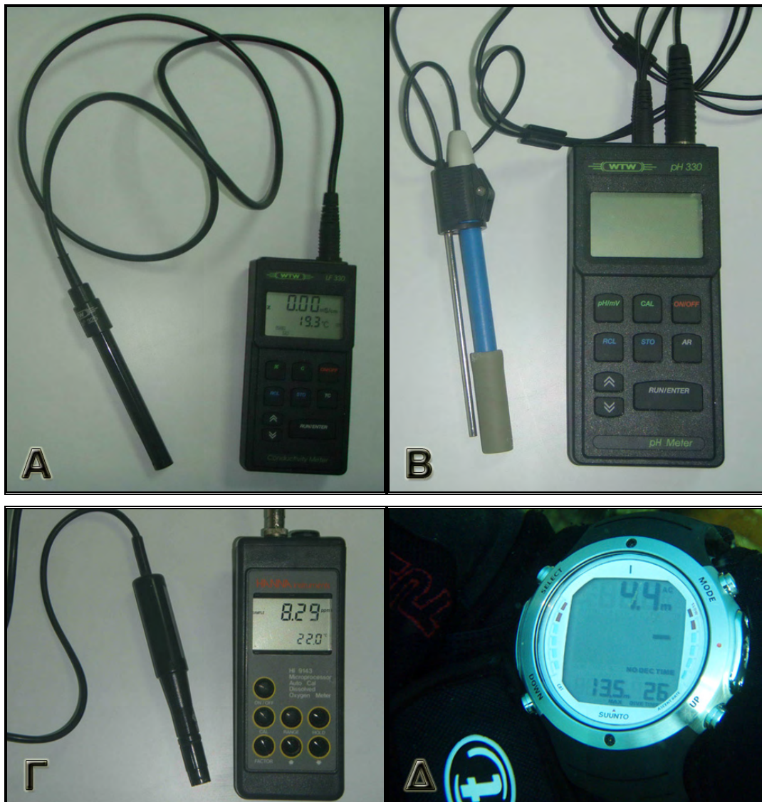
Εικόνα 2.2. Συσκευές μέτρησης των αβιοτικών παραμέτρων στο πεδίο (Α) Αγωγιμόμετρο, (Β) pH μετρο, (Γ) Οξυγονόμετρο, (Δ) καταδυτικό computer D6
