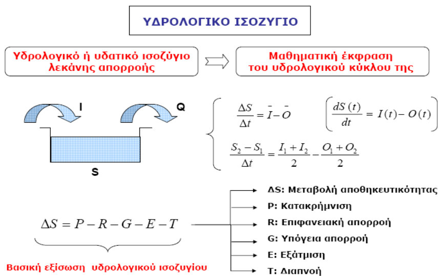
Εικόνα Α.3: Σχηματική αναπαράσταση υδρολογικού ισοζυγίου λεκάνης απορροής.
