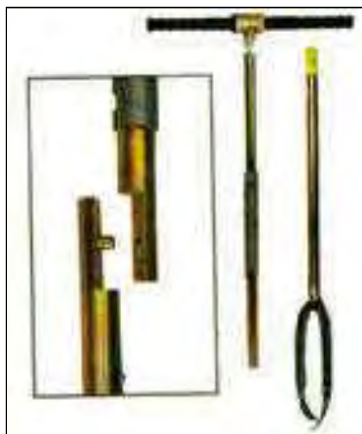
Εικόνα 6.2 Δειγματολήπτης τύπου edelman
