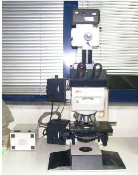
Εικόνα 4: Μικροσκόπιο αντίθετης φάσης (Leica DRMB), με σύστημα φωτογράφισης, για μέτρηση μορφολογικών χαρακτηριστικών.
