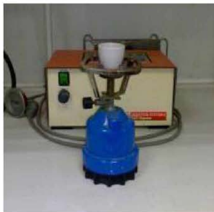
Εικόνα 2.8β: Πρόκαυση δείγματος
