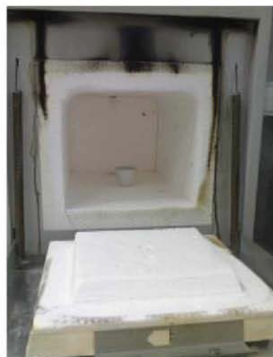
Εικόνα 2.8ε: κλίβανος αποτέφρωσης (Carbolite) ανοιχτός
