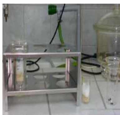
Εικόνα 2.5β: Μικρός & μεγάλος υαλοθμός
