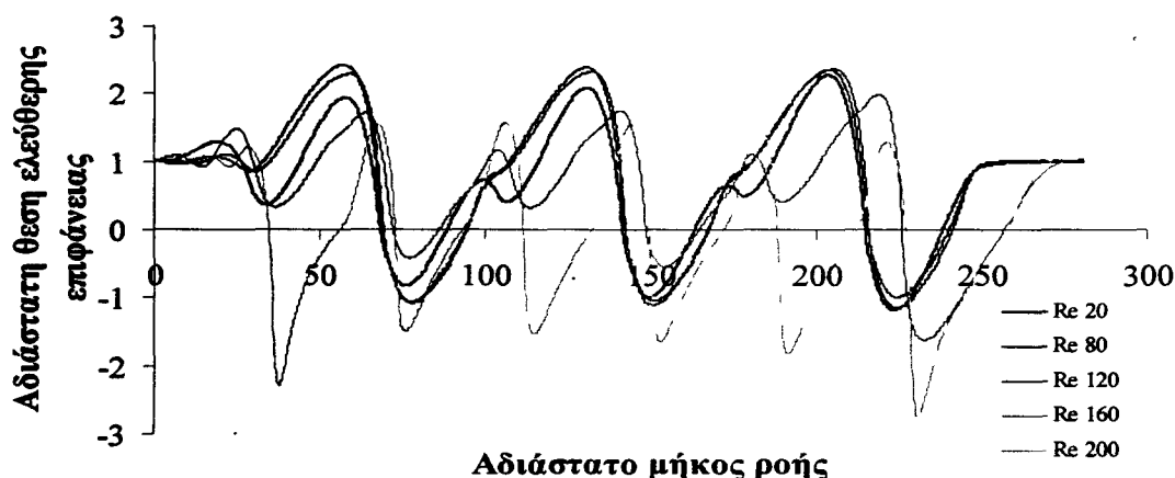
Σχήμα 5.28: Η μορφή της ελεύθερης επιφάνειας για βάθος τοιχώματος 0,012 m
