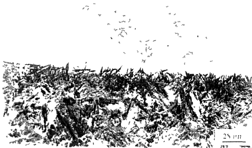
Σχ. 2.19: Η μικροδομή της Ε Π του δοκιμίου που είχε επικαλυφθεί με αιωρημα σκονης γραφίτη σε αιθανολη και ακτινοβολήθηκε με ισχύ 1300 W, διαμετρο δέσμης 3 mm, ταχύτητα σάρωσης 0.8 m/min και 2 περάσματα της δέσμης laser Nital 2%
