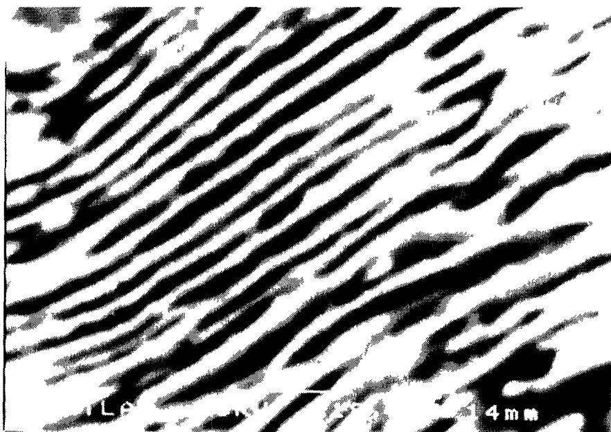
Σχ. 4.2: Εναλλασσόμενες λαμέλλες \text{Fe}_3\text{C} και φερρίτη σε περλιτική μικροδομή του χάλυβα Ck-60
