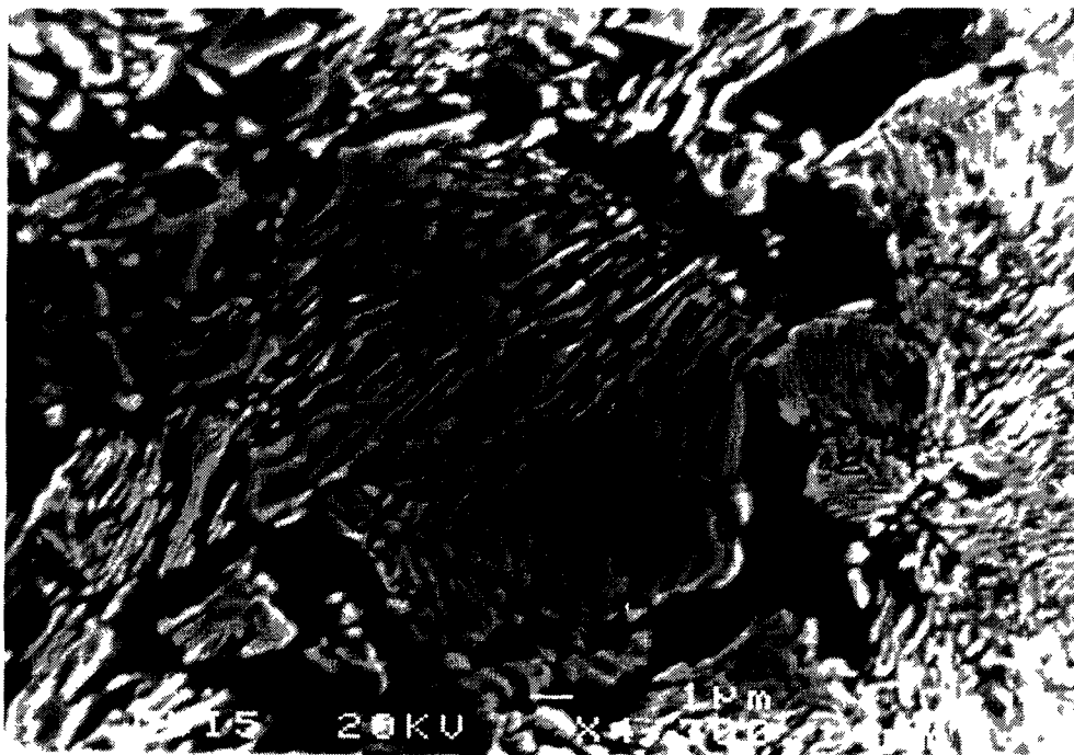
Σχ. 5.3: Η αρχική μικροδομή του χάλυβα Ck-60, αποτελούμενη από λαμελλοειδή περλίτη και προευτηκτοειδή φερρίτη.
