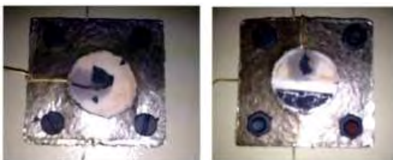
Εικόνα 6.1: Πελλέτα YSZ με αποκόλληση σιδήρου.
