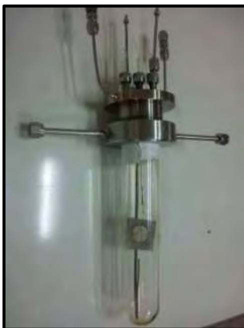
Εικόνα 3.5: Αντιδραστήρας μονού θαλάμου συνεχούς ροής με ανάδευση με μεταλλικό φουσητήρα που κατασκευάστηκε για την μελέτη των υλικών και την λήψη ηλεκτροχημικών μετρήσεων.
