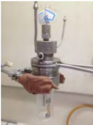
Εικόνα 5.4: Αντιδραστήρας μονού θαλάμου μικρότερου όγκου. Κοντινή λήψη.
