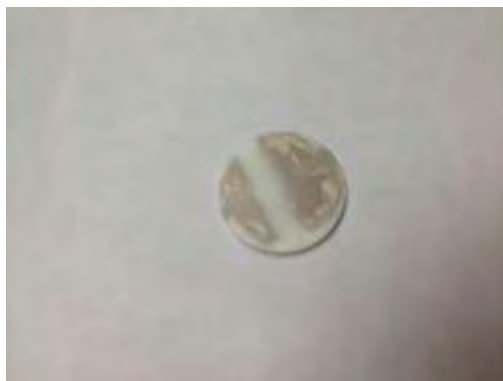
Εικόνα 5.6: Ηλεκτρόδια μέτρησης (μεγάλο) και αναφοράς (μικρό) πελλέτας μετά από αναγωγή.
