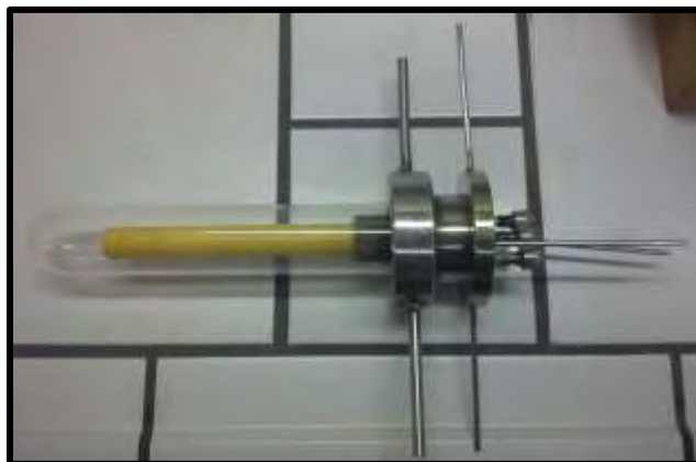
Εικόνα 3.2: Αρχικός αντιδραστήρας διπλού θαλάμου ( double-chamber reactor ).
