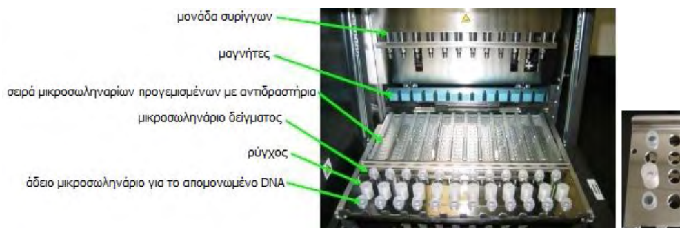
Εικόνα 2. Τοποθέτηση σε προβλεπόμενες θέσεις του συστήματος Magtraction.
