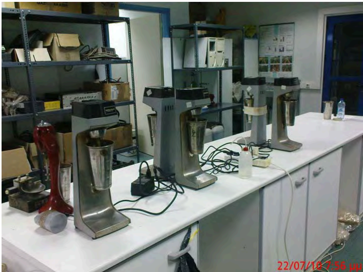
Εικόνα 3.8. Οι ηλεκτρικοί αναδευτήρες
