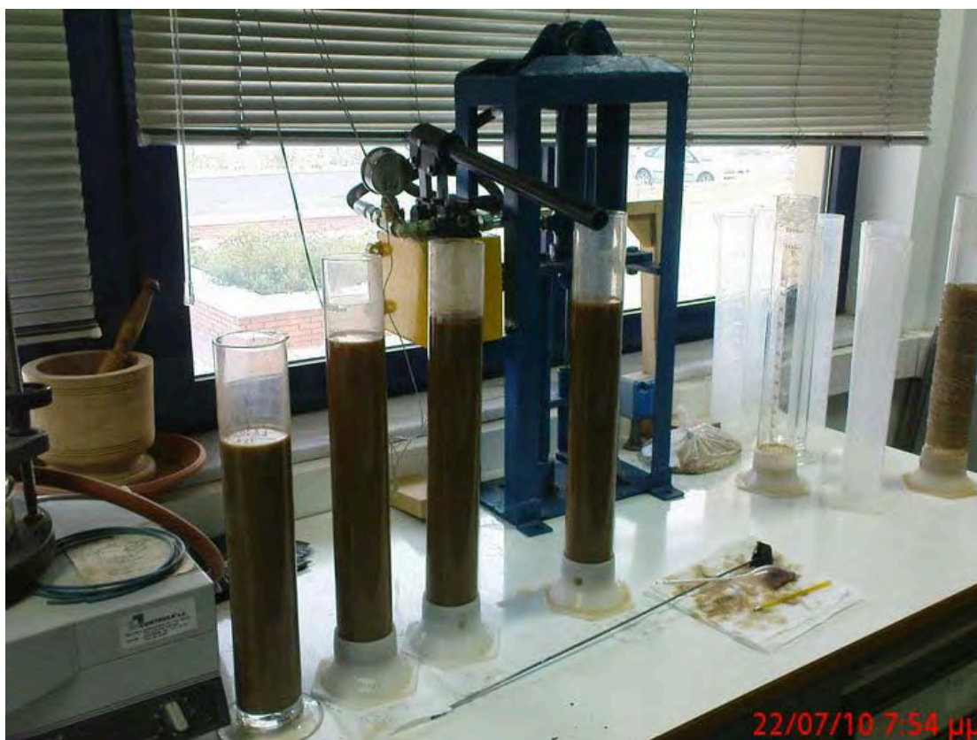
Εικόνα 3.9. Οι φιάλες που χρησιμοποιήθηκαν γεμάτες με εδαφικό διάλυμα
