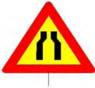
ΣΧΗΜΑ 2.10: Κ-5 Επικίνδυνη στένωση οδοστρώματος και στις δύο πλευρές
