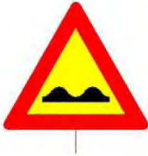
ΣΧΗΜΑ 2.8: Κ-9 Επικίνδυνα ανώμαλο οδόστρωμα σε κακή κατάσταση
