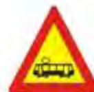
K-41 Κίνδυνος λόγω ισόπεδης διάβασης τροχιοδρόμου χωρίς κινητά φράγματα.
