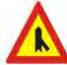
K-29b Διακλάδωση με λοξή οδό δεξιά, οι επί της οποίας κινούμενοι οφείλουν να παραχωρήσουν προτεραιότητα.
