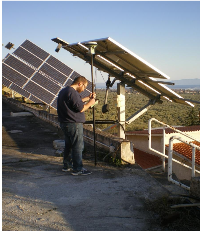
Σχήμα 3.4: Τοπογραφική αποτύπωση με τη χρήση συστήματος GPS
