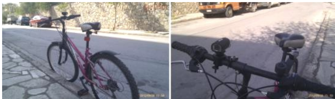
Εικόνα 27 Το ποδήλατο καταγραφής οδών που χρησιμοποιήθηκε με ενσωματωμένη ψηφιακή κάμερα στο τιμόνι (Φωτογραφία από την καταγραφή στην Νέα Ιωνία)
