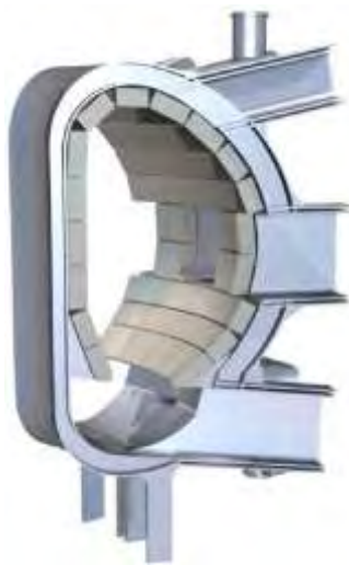
Σχήμα 1.4 Μανδύας (breeder blanket) αντιδραστήρα σύντηξης (EFDA 2012)
