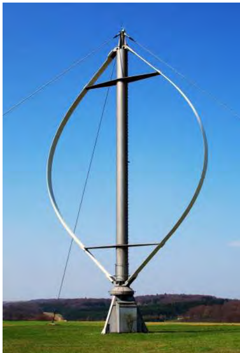
Σχήμα 3: Αναπαράσταση ανεμογεννήτριας κάθετου άξονα
