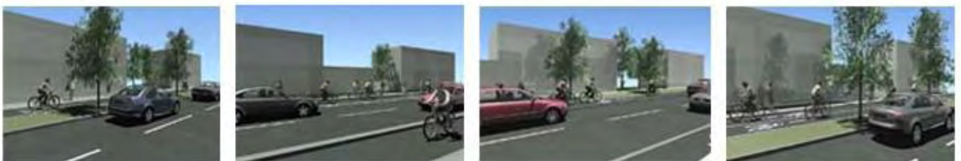
Εικόνα 4.4: Διάφοροι τύποι διαχωρισμού διαδρομών με νησίδα
