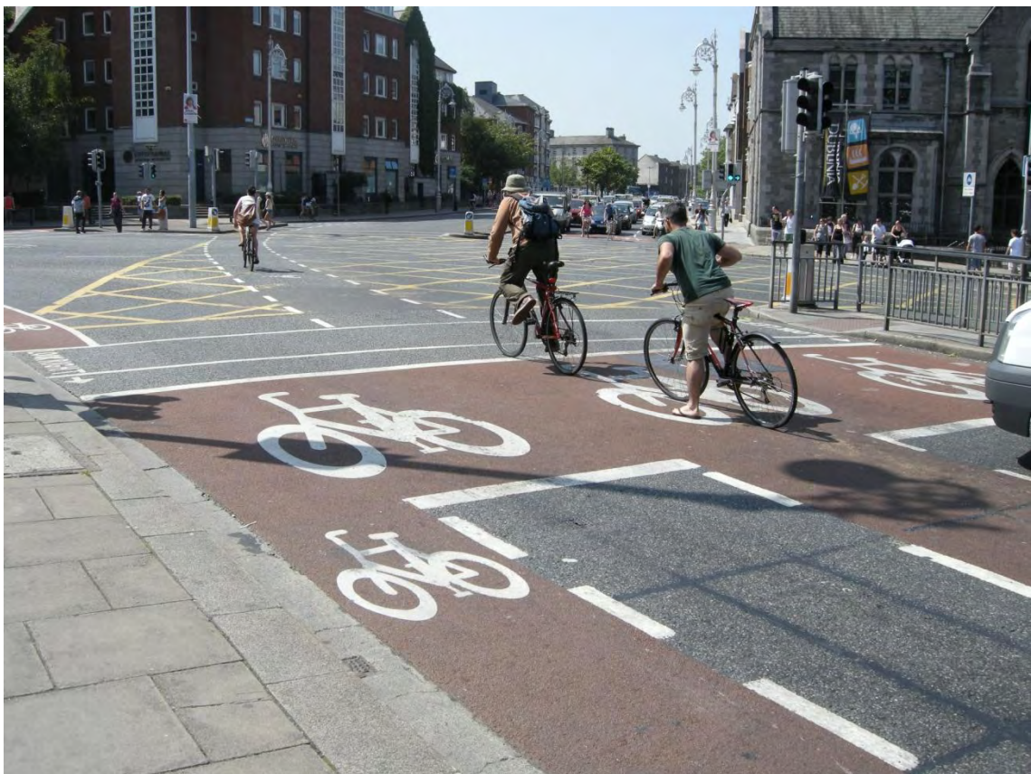
Εικόνα 4.7: Θύλακας αναμονής στο Δουβλίνο
