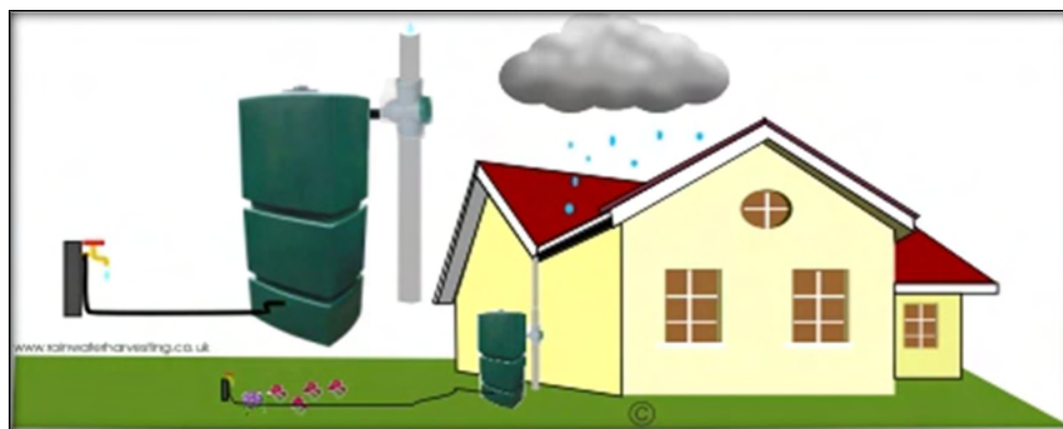
Σχήμα 3: Υπέργεια δεξαμενή συλλογής βρόχινου νερού
