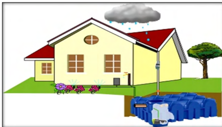
Σχήμα 5: Υπόγεια δεξαμενή συλλογής βρόχινου νερού
