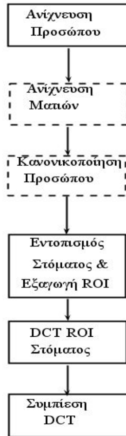
Σχήμα 4.1: Εξαγωγή χαρακτηριστικών από την περιοχή του στόματος με σκοπό την Οπτική Αναγνώριση Ομιλίας
