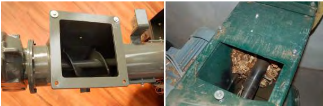
Εικόνα 13 Παραδείγματα από κοχλίες μεταφοράς για λέβητες τεμαχισμένου ξύλου. Αυτό το σύστημα τροφοδοσίας είναι πολύ ευαίσθητο στο μέγεθος των τεμαχιδίων – ένα καύσιμο μεγαλύτερου μεγέθους μπορεί να μπλοκάρει τον κοχλία. ( http://bisyplan.bioenarea.eu/html-files-gr/01-01.pdf )
