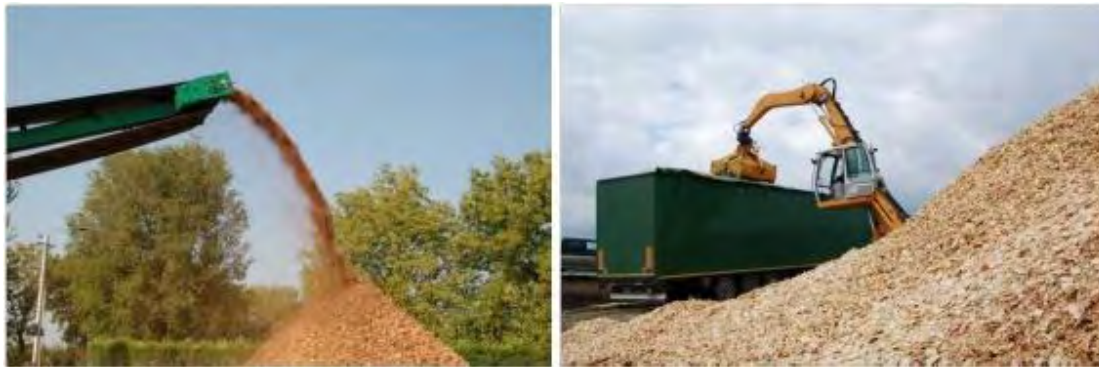
Εικόνα 12 Συμπεριφερόμενα περίπου ως ρευστό, τα τεμαχίδια ξύλου προσαρμόζονται σε διάφορα σχήματα, βελτιστοποιώντας έτσι τη μεταφορά και την αποθήκευση
