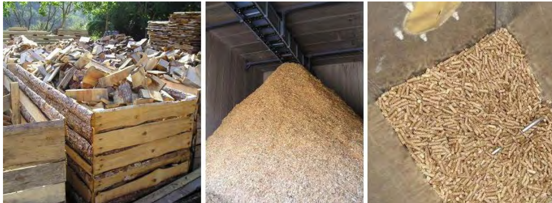
Εικόνα 20 Το μέγεθος και το σχήμα των τεμαχιδίων ξύλου παίζουν σημαντικό ρόλο στον καθορισμό της χύδην πυκνότητας. Χαλαρά κομμάτια ξύλου (αριστερά) και τεμαχιδίων ξύλου (κέντρο) μπορεί να έχουν παρόμοια φαινομενικό όγκο, ενώ οι πελλέτες (δεξιά) λόγω του μικρού και ομοιογενούς τους μεγέθους μπορεί να έχουν μεγαλύτερη χύδην πυκνότητα
