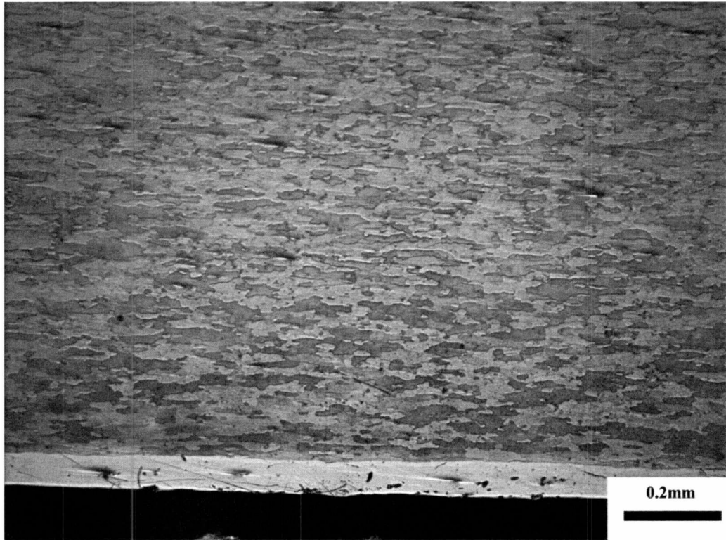
Σχ. 4.13: (KL10-6) Clad layer στο κάτω έλασμα
