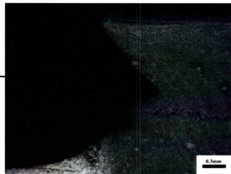
(β) Εγκάρσια τομή της επιφάνειας θραύσης
