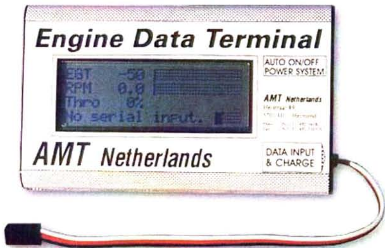
Εικόνα Π. 14. Το τερματικό παρακολούθησης της λειτουργίας του κινητήρα
