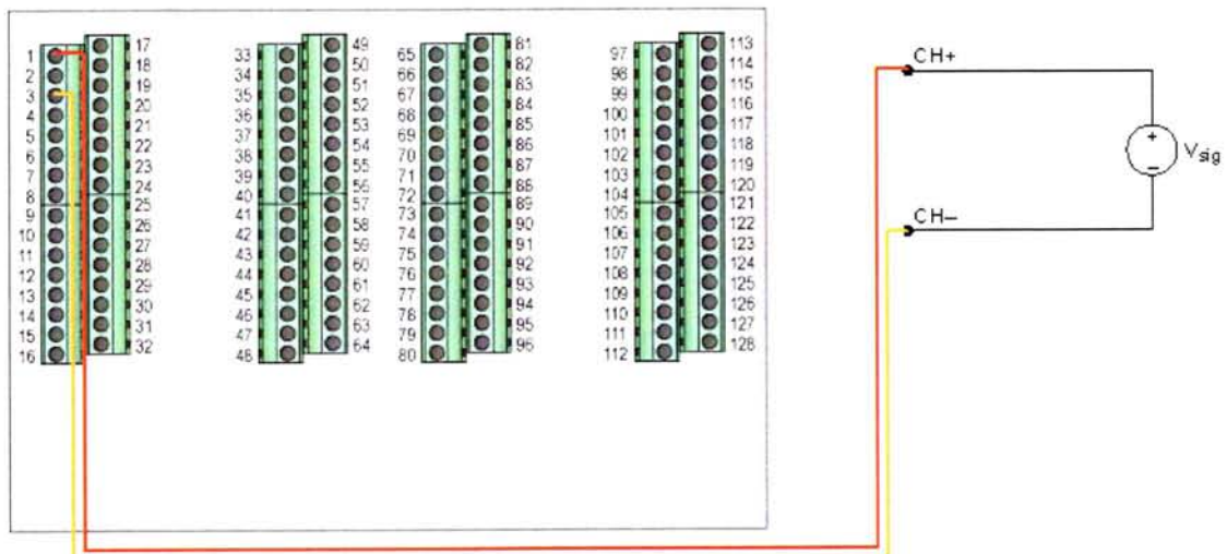
Εικόνα 26. Συνδεσμολογία καναλιού Ai0
