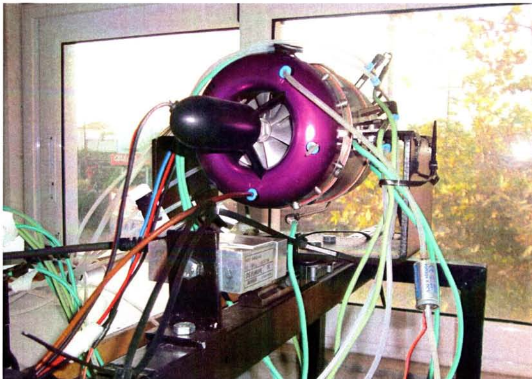
Εικόνα 8. Αισθητήρες πίεσης σε διατομές του κινητήρα
