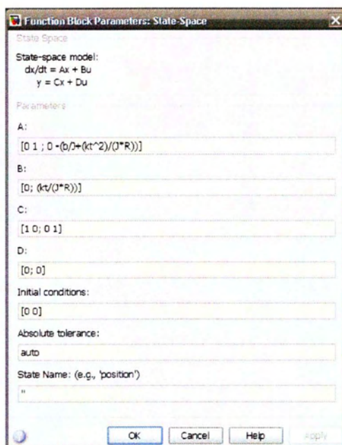
Σχήμα 3.6: State-space block του συστήματος χωρίς τους μη γραμμικούς όρους
