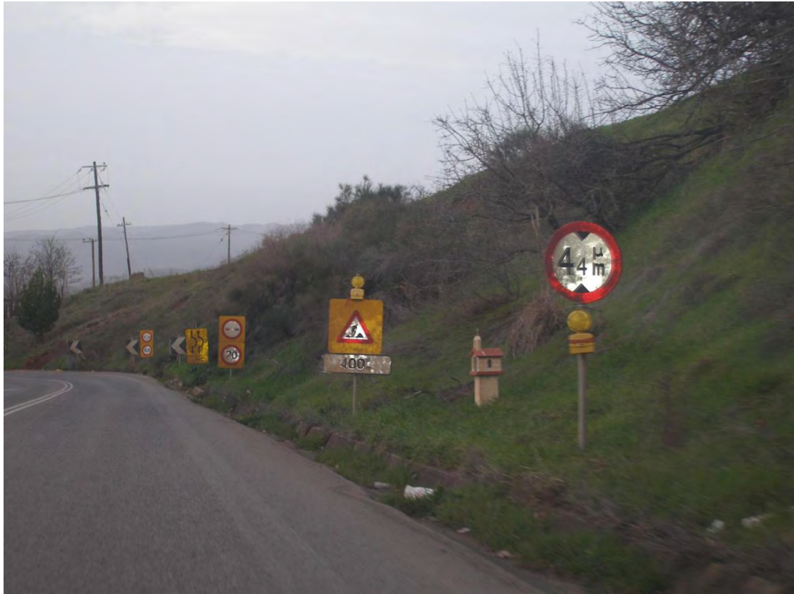
Εικόνα 5.2: Παράδειγμα κακής σήμανσης ζώνης έργων
