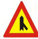
K-29b Διακλάδωση με λοξή οδό δεξιά, οι επί της οποίας κινούμενοι οφείλουν να παραχωρήσουν προτεραιότητα.
