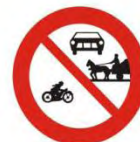
P-20 Απαγορεύεται η είσοδος σε οχήματα ορισμένων κατηγοριών (π.χ. σε μηχανοκίνητα και ζωήλατα οχήματα).
