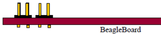
Εικόνα 12 – Τοποθέτηση του header
