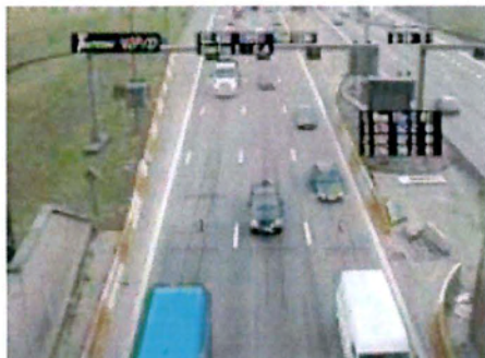
Εικόνα: λειτουργία συστήματος ψηφιακής επεξεργασίας εικόνας. Διακρίνονται οι γραμμές ανίχνευσης[8].
