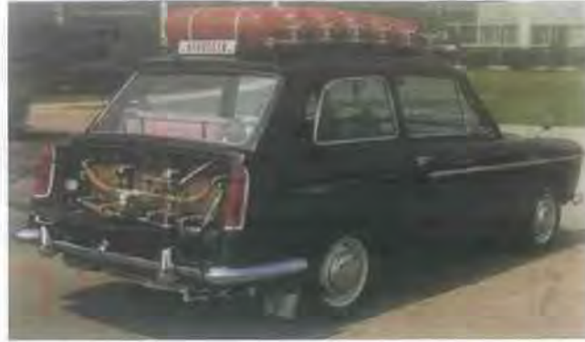
Σχήμα 1-5: Ένα από τα πρώιμα ηλεκτρικά αμάξια, σχεδιασμένο από τον Karl Kordesch, που είχε ως πηγή ισχύος μια συστοιχία αλκαλικών κυψελών καυσίμου [28].
