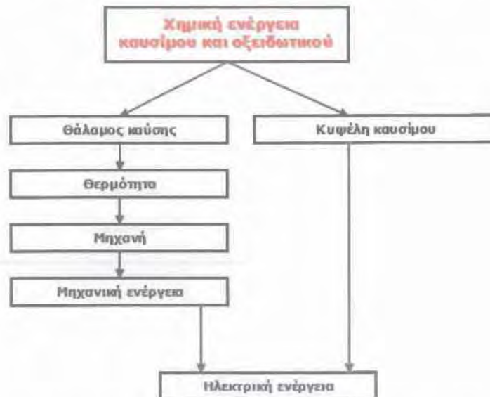
Σχήμα 1- 1: Παραγωγή ηλεκτρικής ενέργειας μέσω συμβατού τρόπου και μέσω κυψέλης καυσίμου [1].
