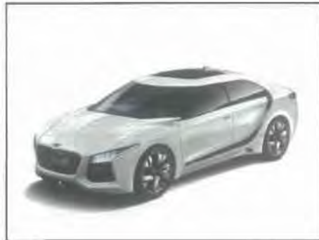
Σχήμα 1- 13: Το νέο HyundaiBlue2 που τροφοδοτείται από κινητήρα κυψελών καυσίμου ισχύος 90kW. [19]
