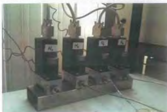
Σχήμα 3-3: Ψηφιακά ροόμετρα μάζας. Οι ετικέτες επάνω τους αναγράφουν το αέριο που φέρει η γραμμή και ελέγχεται από το συγκεκριμένο ροόμετρο.
