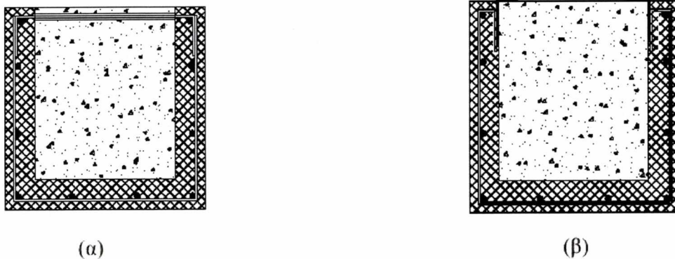
Σχήμα 7.1 Ενίσχυση υποστύλωματος με μανδύα οπλισμένου σκυροδέματος ανοικτού τύπου. (α) Αγκύρωση συνδετήρων με διαμπερή σπή και συγκόλληση. (β) Αγκύρωση συνδετήρων με συγκόλληση σε γωνιακά βλητρομένα στο υπάρχον στοιχείο.
