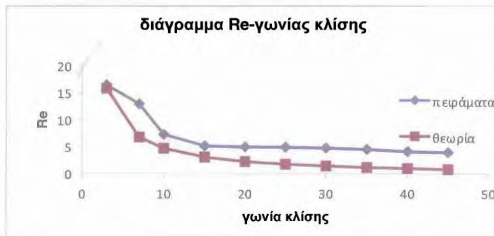
Διάγραμμα 4.2.3.1 Σύγκριση πειραματικών Re_{crit} και θεωρητικών Re_{crit} συναρτήσει της γωνίας κλίσης, για διάλυμα γλυκερίνης-νερού με 68% γλυκερίνη
